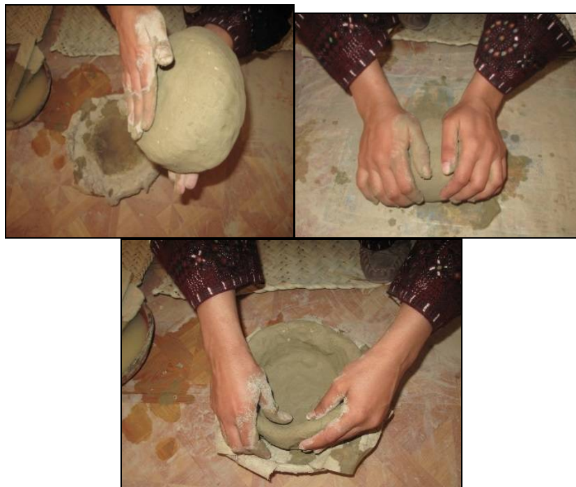
عکس ۱۲- ورز دادن گل عکس ۱۳- قرار دادن گل بر روی بنو عکس ۱۴- بالا کشیدن گل
