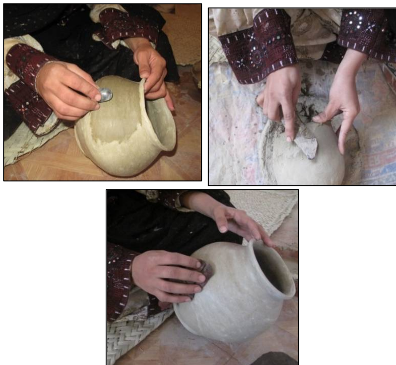
عکس ۱۸- تراشیدن ته ظرف عکس ۱۹- صیقل دادن ظرف عکس ۲۰- مالیدن چربی بر سطح ظرف
