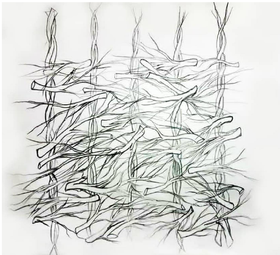
طرح ۲- چگونگی قرار دادن شاخ و برگ درختان بر کمر بند بافته شده
