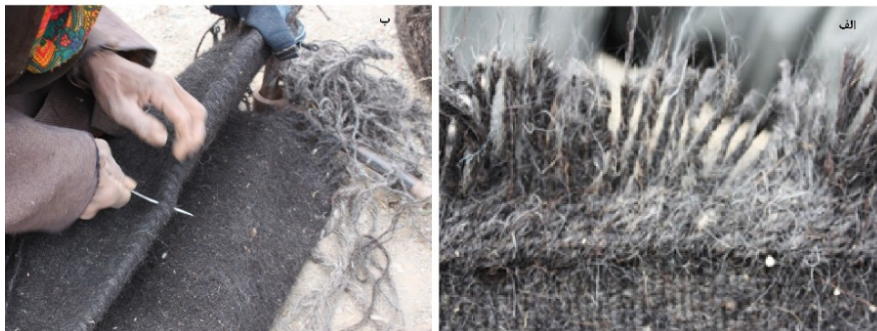
عکس ۱۲- الف) برش و گره زدن نخ‌های تار و ب) اتصال لت‌ها به کمک جوال دوز (نگارندگان، ۱۳۹۸).
