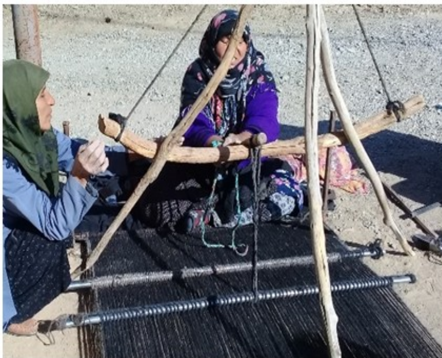
عکس ۹- الف) اتصال اجزاء گُله (سه‌پایه، کمانک و روبندک) (نگارندگان، ۱۳۹۸).
