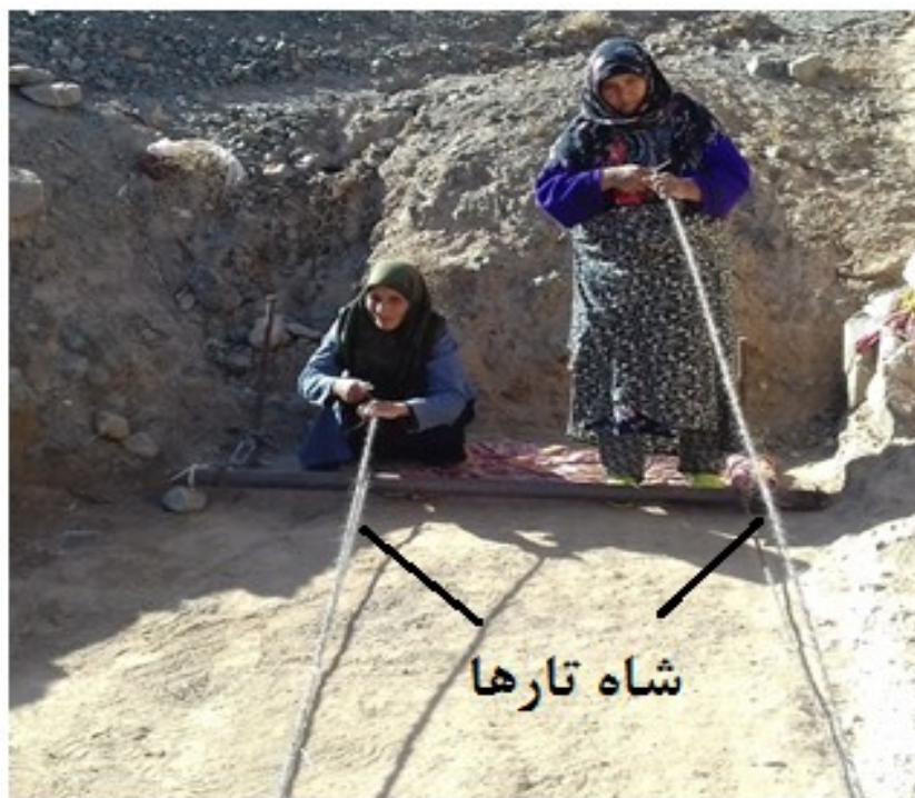
عکس ۶- قرار دادن شاه تارها (یا زه پلاس) در دو سمت میله‌ها (نگارندگان، ۱۳۹۸).
