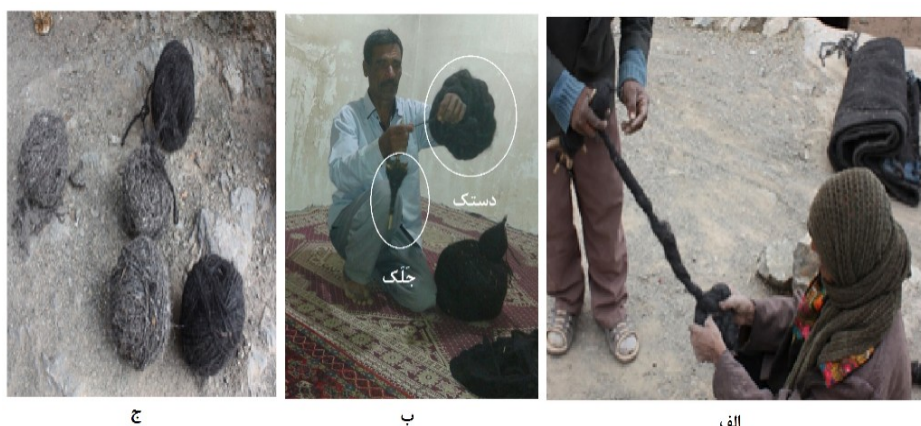
عکس ۳- الف) فشردن سازی و تهیه دستک، ب) ریسیدن الیاف با جَلک و ج) گلوله (یا گروه) نخ (نگارندگان، ۱۳۹۸).
