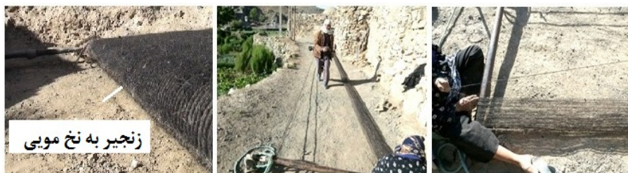
عکس ۷- الف) تنظیم کشش و جانمایی نخ چله بر روی میله سرکار، ب) فرآیند چله‌دوانی توسط شخص چله‌پیما و ج) چله‌های زنجیره شده به نخ مویی چندلا (نگارندگان، ۱۳۹۸).
