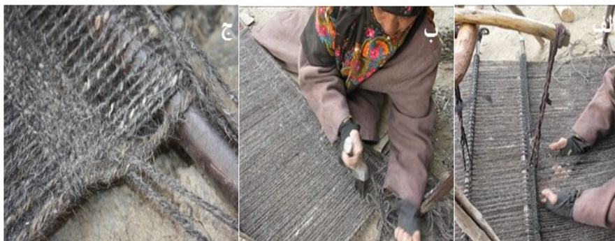
عکس ۱۰- الف) عبور نخ پود از میان تارها به کمک انگشتان دست، ب) دفتین زدن به کمک دسّک و ج) چند رج از نخ‌های پود بافته‌شده (نگارندگان، ۱۳۹۸).
