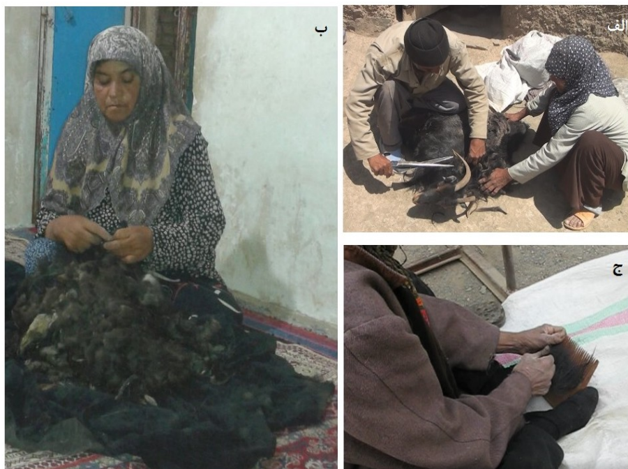
عکس ۲- الف) چیدن موهای بز، ب) پاک‌سازی اولیه الیاف و ج) حلاجی با شانه چوبی (نگارندگان، ۱۳۹۸).
