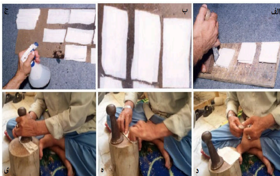
عکس ۶- الف) برش زدن پارچه‌ها، ب) پارچه‌های آماده‌شده برای تخت گیوه، ج) مرطوب کردن پارچه‌ها، د) قرار دادن تکه‌های پارچه بر روی هم، ه) تا زدن پارچه‌ها، ی) کوبیدن پارچه‌ها (یا دنده‌ها) (نگارندگان، ۱۴۰۴).
