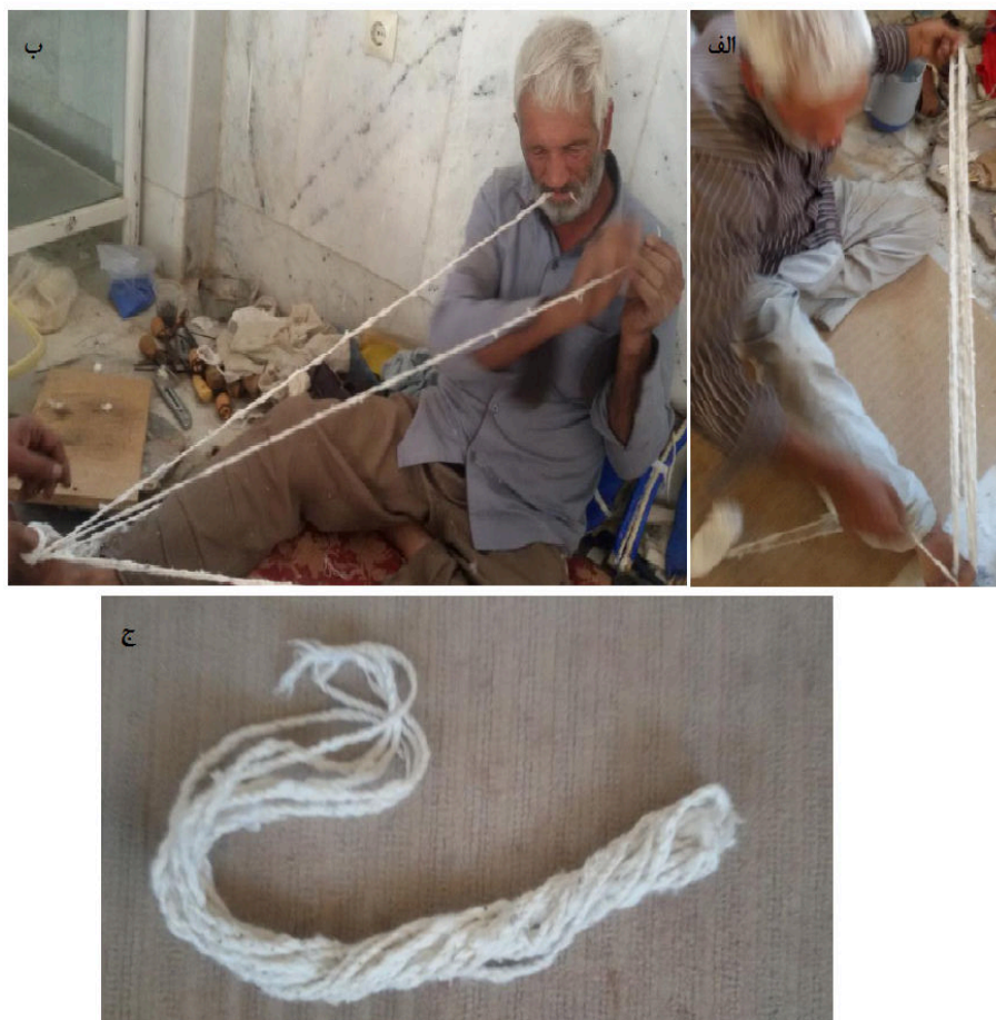
عکس ۵-الف) ۸ لا کردن نخ پنبه‌ای، ب) تاب دادن نخ پنبه‌ای و ج) نخ پُرک تابیده شده (نگارندگان، ۱۴۰۴).
