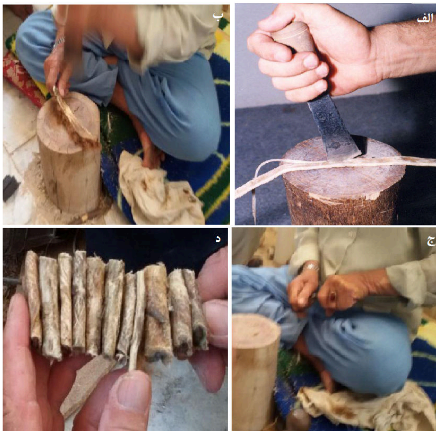
عکس ۳- الف) برش زدن خام، ب) کوبیدن خام، ج) سوراخ کردن خام و د) خام‌های آماده (نگارندگان، ۱۴۰۴).
