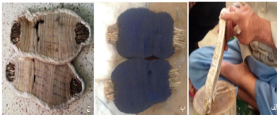
عکس ۱۲. الف) کتیرا زدن، ب) تخت گیوه رنگ‌شده، ج) تخت گیوه ساده (نگارندگان، ۱۴۰۴).
