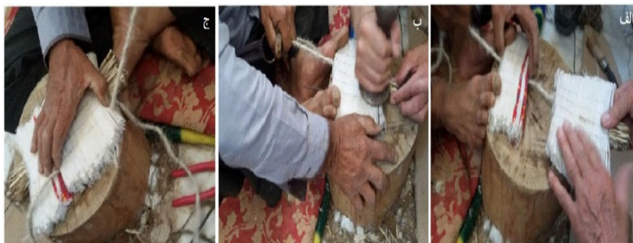
عکس ۸- الف) اضافه کردن پاشنه به سینه، ب) رد کردن تیر اول از پنجه و سینه و کشیدن با اشکلک، ج) طریقه قرار گرفتن دنده‌ها در پنجه و پاشنه (نگارندگان، ۱۴۰۴).
