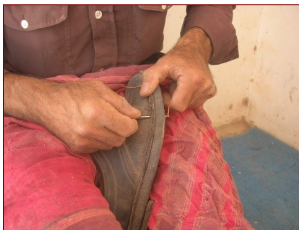
عکس ۹- دوخت رویه به زیره پای پوش (آرشیو میراث فرهنگی سرایان)
