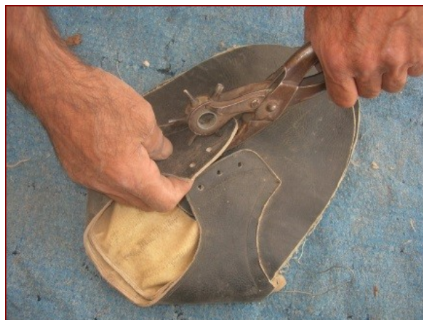
عکس ۵- آماده‌سازی رویه پیش از کشیدن روی قالب (آرشیو میراث فرهنگی سرایان)
