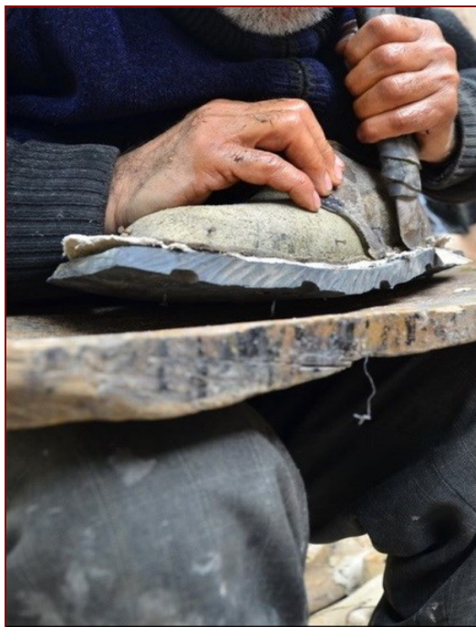
عکس ۸- برش اطراف زیره به وسیله گزدن، و هماهنگ کردن شکل و اندازه آن با کف قالب (www.tasnimnews.com)
