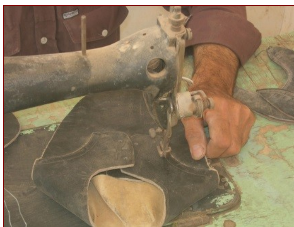
عکس ۴- آماده‌سازی و دوخت اجزای رویه با استفاده از چرخ دستی (آرشیو میراث فرهنگی سرایان)
