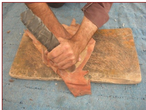
عکس ۱- برش چرم با استفاده از گزن (آرشیو میراث فرهنگی سرایان)
