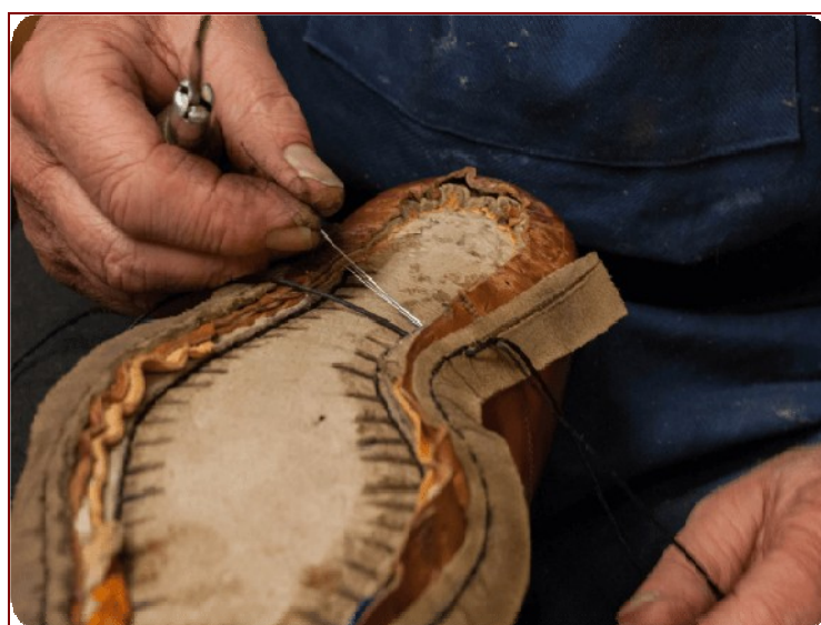
عکس ۷- دوخت سروار به کفی داخلی کفش ( www.sisishoe.com )
