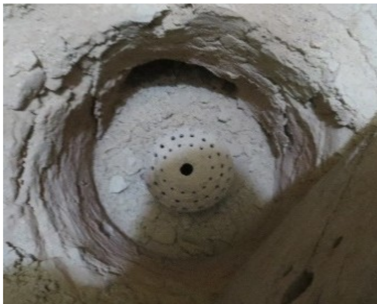
عکس ۱۷- مشعل کوزه گازی که در وسط کوره قرار دارد منبع: (نگارندگان ۱۳۹۹)
