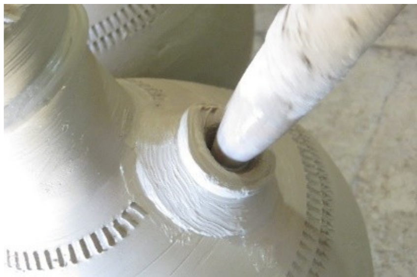
عکس ۱۱- ایجاد سوراخ برای جای نی قلیان توسط ابزار مخصوص منبع: (همان)
