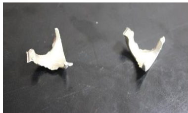
تصویر ۳۷- شکل اولیه دو بازویی انگشتر پس از ریخته‌گری
